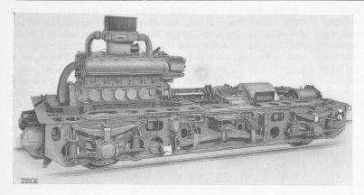
Abb. 1. 600 PS Triebrad-Drehgestell des dreiteiligen Diesel-Schnelltriebwagens der D. R.
