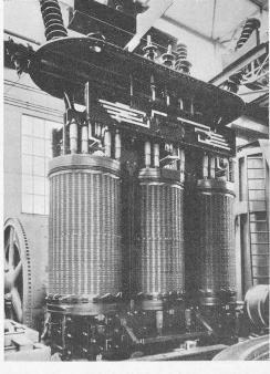
Abb. 55 u. 56. Dreiphasen-Transformator 12500 kVA der Ateliers de Sécheron, Genève, für 8200, 8500, 8800 und 9100 V auf 150000 V mit unter Last bedienbarem Anzapfungsschalter. Links Blechkörper des Transformators.
