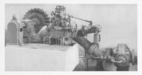
Abb. 53. Niederenbachturbine, H = 1000 m, N = 11450 PS. Escher Wyss Maschinenfabriken A.-G., Zürich.
