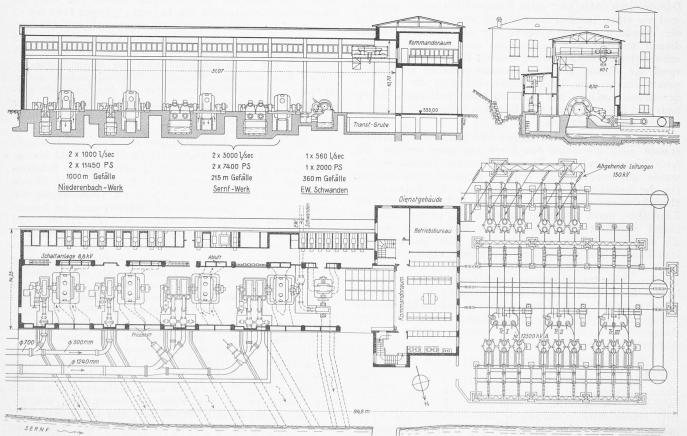
Abb. 45. Grundriss und Schnitte der gemeinsamen Zentrale Schwanden des Sernf- und Niederenbachwerkes. - Masstab 1:500.
