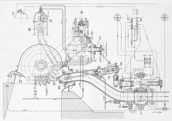
Abb. 52. Niederenbachturbine. — Legende: A Regler und Servomotor, B Regler-Oelpumpe, C Schliesszylinder, D Nadel, E Schliessfeder, F Oelbremse, G Ablenker, H Sicherheitsregler, I Kippschalter, K Kugelschieber-Steuerventil, L Kugelschieber, M Bremsdüse.
