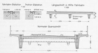
Abb. 7. Schnitte 1:120 und Einzelheiten der Fahrbahn.
