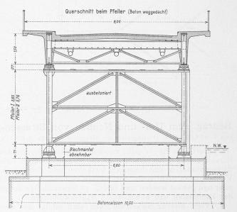
Abb. 6. Reussbrücke Gisikon, Pfeiler. — Masstab 1:120.
