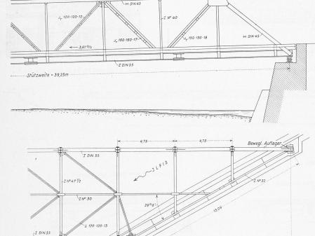
Abb. 2. Grundriss, Ansicht und Schnitte der Strassenbrücke über die Ilfis. — Masstab 1:200.
