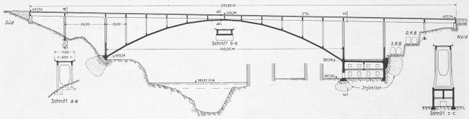
Eisenbeton-Hochbrücke des nichtprämiierten Entwurfs Nr. 28. Verfasser Ing. R. Maillart und Ing. A. Bodmer, Genf. — Masstab 1:1400.
