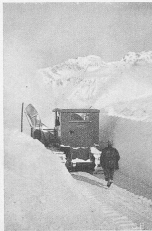
Abb. 10 und 11. Neue „Raco“-Cietrac-Schleuder am Arlberg: erster Schnitt.
