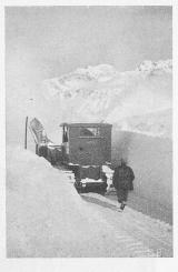
Abb. 10 und 11. Neue "Raco"-Cletrac-Schleuder am Arlberg: erster Schnitt.
