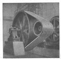
Antrieb eines Kompressors, 125 PS.
