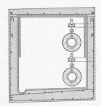
Abb. 3. Schnitte 1:30 durch einen geschlossenen und einen bekriechbaren Heizkanal, Rohrleitungsanordnung.
