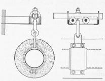
Abb. 4. Konstruktion der Rohrleitungsaufhängung mit Rollenlagern, 1:10.
