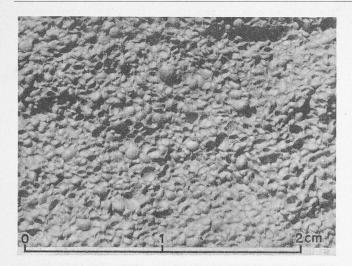
Abb. 3. Eisenoolithisches Erz aus dem Versuchstollen, vierfach vergrössert. Eisengehalt rd.  $36\,\%_0$ .
