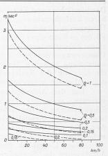
Abb. 1. Höchstbeschleunigungen bei verschiedenen Reibungsgraden und Steigungen.
