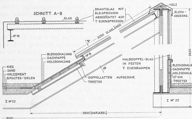
Abb. 9. Einzelheiten des Sheddaches. — Massstab 1:30.
