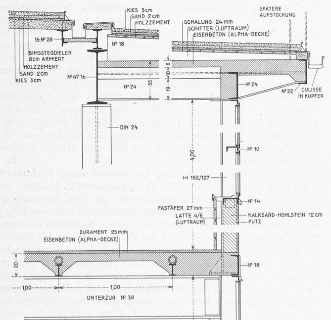
Abb. 10. Schnitt 1:30 durch den zweigeschossigen Neubauteil (vergl. Abb. 4 und 7).
