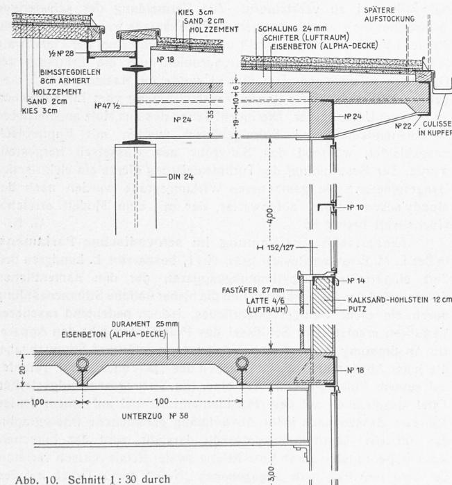
Abb. 10. Schnitt 1:30 durch den zweigeschossigen Neubau teil (vergl. Abb. 4 und 7).
