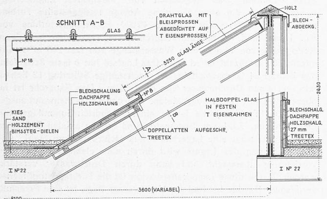
Abb. 9. Einzelheiten des Sheddaches. — Maßstab 1 : 30.
