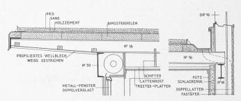
Abb. 11. Konstruktive Durchbildung des Bureaudaches. — Masstab 1:30.
