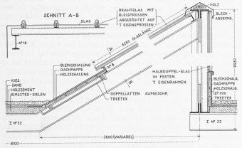
Abb. 9. Einzelheiten des Sheddaches. - Masstab 1:30.
