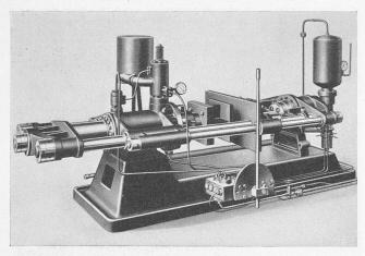
Abb. 5. Warmpressgussmaschine Bühler (Uzwil). (Im Vordergrund Steuerventilblock und Steuerhebel.)
