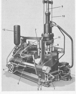
Abb. 2. Spritzgussmaschine mit "kalter" Druckkammer, System Polak.
