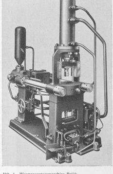
Abb. 4. Warmpressgussmaschine Polàk.
