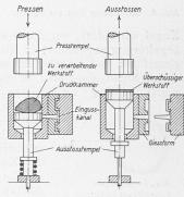
Abb. 3. Warmpressgussverfahren nach Polak (schematisch).
