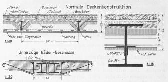
Abb. 33. Einzelheiten der Stahlskelett-Deckenkonstruktionen, 1:30 und 1:15.
