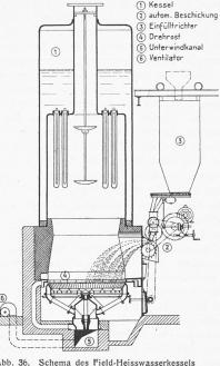
Abb. 36. Schema des Field-Heisswasserkessels mit mechanisch beschicktem Drehrost Patent Groll
