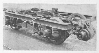
Abb. 2. SBB-Drehgestell neuere Bauart Schlieren, ohne Achshalter, z. T. mit Rollenlagern SKF und SRO ausgerüstet.
