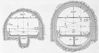
Abb. 23. Normalprofil in standfestem Abb. 22. Druckprofil mit Sohlengewölbe. Gebirge. Projekt Ing. Ed. u. Gg. Gruner, Basel. Masstab 1:250.
