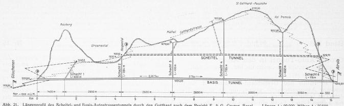
Abb. 21. Längenprofil des Scheitel- und Basis-Autostrassentunnels durch den Gotthard nach dem Projekt E. & G. Gruner, Basel. — Längen 1:90000, Höhen 1:22500.
