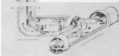
Abb. 25. Stereometrie einer der fünf Tunnel-Ventilationsanlagen nach Projekt Ed. u. Gg. Gruner. - 1:600.
