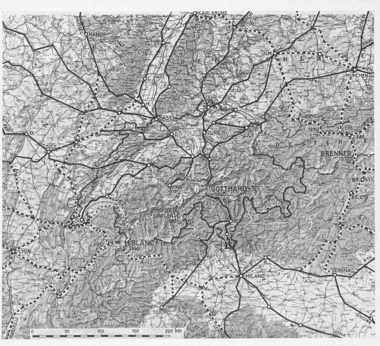
Abb. 15. Uebersichtskarte eines ganzjährigen Auto-Fernverkehrs Nord-Süd in den Zentralalpen. — Masstab 1:3500000. Schwarz Gotthardzone, kräftig punktiert Möglichkeiten der Umfahrung der Schweiz (fein punktiert Simplonroute).
