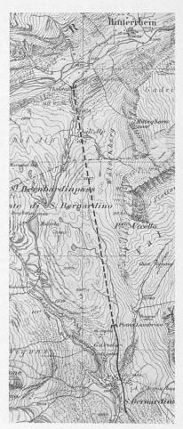
Abb. 19. St. Bernhardin mit Passtrasse und projekt. Tunnel von 5,1 km, Südportal-Kote etwa 1700. — Masstab der Karte 1:65000.
