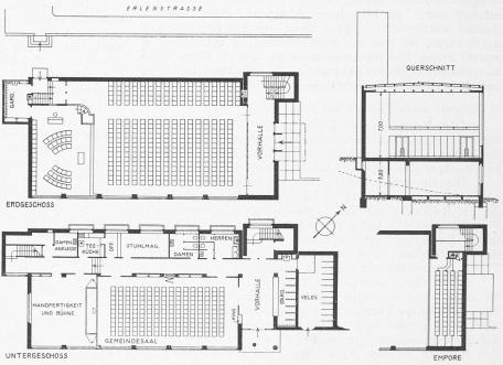
Abb. 1. Grundrisse und Querschnitt der Kirche Gerliswil. - Masstab 1:400.
