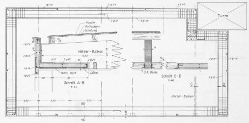
Abb. 6. Horizontalrahmen des Daches 1:200, Schnitte dazu 1:40.
