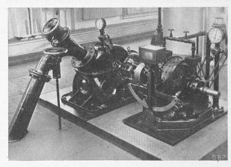
Abb. 8. Zweidüsige Freistrahlturbine (Wasserzuführung zur untern Düse nicht sichtbar, weil sie unter dem Maschinenhausboden liegt).
