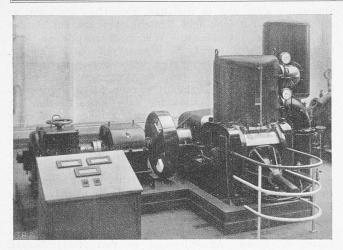
Abb. 4. Ventillose Kolbenpumpe mit oszillierendem Zylinder, von der Messpultseite.
