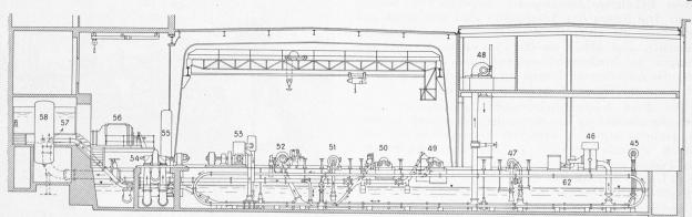
Abb. 1. Längsschnitt (1:300) durch Windkesselraum und grossen Rohrgraben. — Legende: 45 Versuchsdüse, 46 Modellturbinen (Dogern), 47 Mitteldruck-pumpen (Serie-Parallelpumpen), 48 Kavitationsstand, 49 Zweidüsige Freistrahlturbine, 50 Eindüsige Freistrahlturbine, 51 Hochdruckturbine, 52 Francisturbine, 53 Oszillierende Kolbenpumpe, 54 Niederdruckpumpe, 55 Kleiner Windkessel, 56 Niederdruck-Versuchsturbine, 57 Oberwasserbehälter der N.-D.-T., 58 Grosser Windkessel, 62 Rohrgraben.
