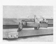
Abb. 17. Abreiss-Schleifkontakt am Messkanal.
