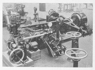
Abb. 7. Freistrahlturbinengruppe, vom automatischen Regulator aus.
