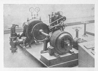
Abb. 5. Spiralturbinengruppe mit Regulator und Druckregler, elektrischem Generator und Erregergruppe.
