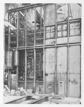
Abb. 14. Einrohr-Dampferzeuger von Gebr. Sulzer, Winterthur. Dampferzeugung 18 t/h, 100 ata, 450  $^{\circ}$  C.
