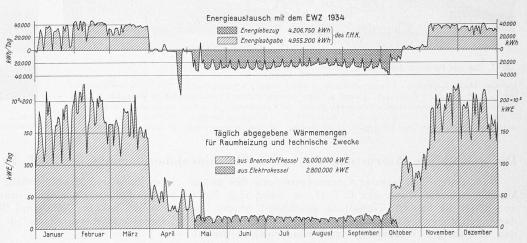
Abb. 5. Charakteristik der Wärmeproduktion und des Energieaustausches des FHK für 1934.
