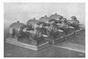
MAAG-ZAHNRADPUMPENGRUPPEN zur Förderung von 150 l/min Oel bei 250°C und 5 at Druck für chemische Fabrik in Basel
