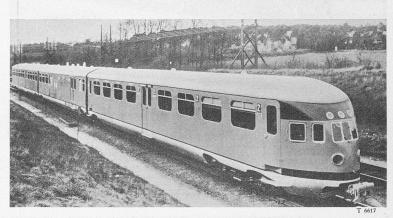
Abb. 1. Dieselelektrischer Motorzug der holländischen Staatsbahnen (SKF Rollenlager).
