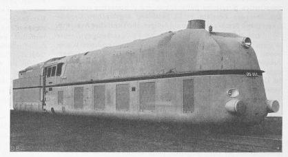
Abb. 5. 2 C 2 · Stromlinienlokomotive der Deutschen Reichsbahn (Borsig, Berlin). Der schwarze Streifen ist aufgemalt und nicht etwa ein Schlitz in der Verkleidung.
