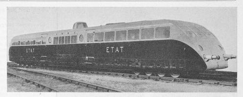
Abb. 2. Schnelltriebwagen der französischen Staatsbahn (Bugatti).
