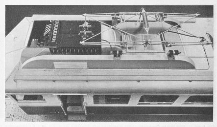
Abb. 4. Anordnung von Stromabnehmer und Transformator auf dem Wagendach.
