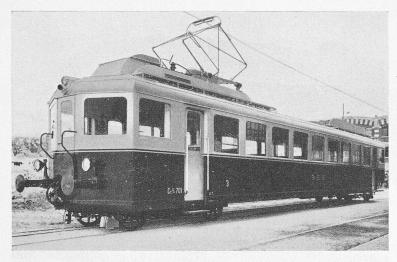
Abb. 2. 200 PS-Leichttriebwagen der BLS, SEB und BN.
