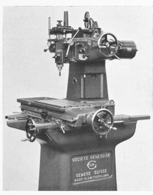
Abb. 11. Genauigkeits-Koordinaten-Bohrmaschine der Société Genevoise.
