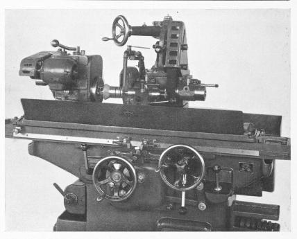
Abb. 8. Kombinierte Rund-, Innen- und Planschleifmaschine (Kellenberger Werkzeugmaschinenfabrik).
