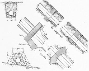
Abb. 43. Normalien der Druckleitung. - Masstab 1:150.
