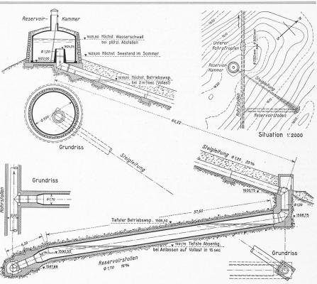
Abb. 39. Einzelheiten des Wasserschlosses in Grundriss und Aufriss, 1:400. — Oben Situation 1:2000.
