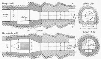
Abb. 37. Rechenkammer beim Uebergang vom Druckstollen zum Rohrstollen. — 1:150.
