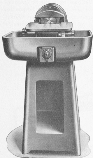
Abb. 4. Diamantscheiben-Schleifmaschine (Fritz Wunderli, Uster).
