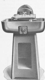
Abb. 4. Diamantscheiben-Schleifmaschine (Fritz Wunderli, Uster).
