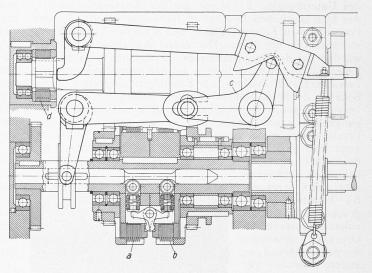
Abb. 3. Doppel-Lamellenkupplung und Lamellenbremse der Drehbank Oerlikon. Masstab 1:5.
