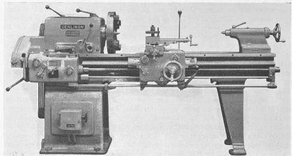
Abb. 1. Schnelldrehbank (Werkzeugmaschinenfabrik Oerlikon).
