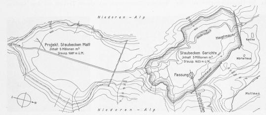
Abb. 22. Die Staubecken Garichte und Matt des Niederenbach-Kraftwerks. - Masstab 1:10000.
