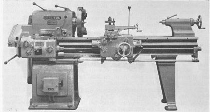
Abb. 1. Schnelldrehbank (Werkzeugmaschinenfabrik Oerlikon).
