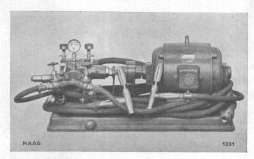
MAAG-HOCHDRUCKWASCHPUMPE zur Reinigung von Autos, Wagons, Schlachthäusern, Maschinenteilen. Regulierbarer Druck bis 40 at.
