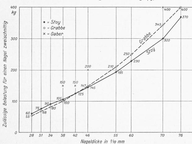
1,5 mm erreicht und überschreitet, dass also bei Bohlen von 50 mm Dicke aufwärts durchweg jene Last als Gebrauchslast anzusehen ist, bei der diese Verschiebung gerade erreicht wird.
