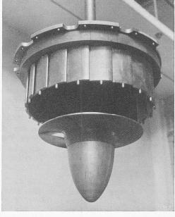
Abb. 2. Leitapparat und Laufrad geschlossen.
