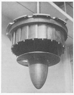
Abb. 2. Leitapparat und Laufrad geschlossen.
