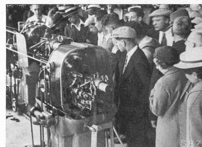
Abb. 25. Schrauben-Automat im Betrieb.
