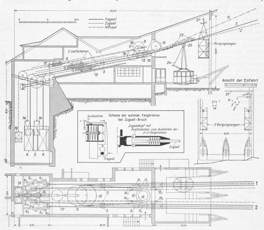
Abb. 5. Talstation der Säntis-Schwebebahn (1:300) und Schema der automatischen Fangbremse.
