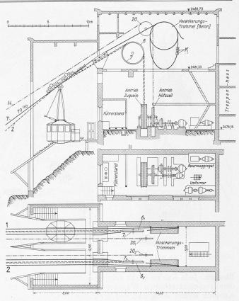
Abb. 6. Bergstation der Säntis-Schwebebahn. - Masstab 1:300.
