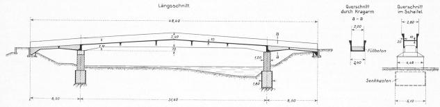
Abb. 1. Schnitte 1:400 des Eisenbetonsteges über die Töss bei Winterthur. Entwurf und Bauleitung von Ing. P. Soutter, Zürich,
