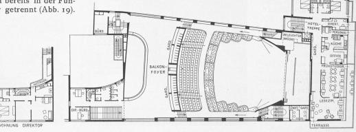
Abb. 11. Grundrisse: links II. Stock Zwischenbau, rechts Balkon-Foyer und I. Stock Hotel. - Masstab 1:500.
