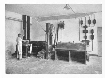
Abb. 11. Vormischer und Zentrifugalsichter im Mehlmagazin 41.
