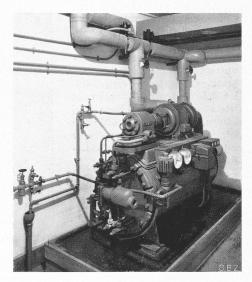
Abb. 19. "Sulzer-Frigozentrale" für 5500 Cal/h.
