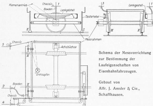
Berichtigte Fassung von Seite 292, Zeile 4 und ff (Bd. 105): Mit dem Drahtzug 2 und der mit dem Taster II beweglichen Umlenkrolle bilden wir die absolute Differenz der Ausschläge der Taster I und II; sie ist dem Tangens des Winkels zwischen Radebene und Schiene proportional. Unter Zwischenschaltung eines Bowdenzuges wird der gewonnene Messwert vom Taster II direkt auf die Schreibvorrichtung übertragen, und der Einfluss der gegenseitigen Bewegungen zwischen Taster und Wagenkasten ausgeschaltet.
