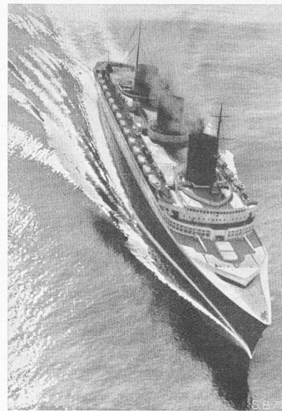
Abb. 2. Bugansicht der „Normandie“, mit schlanker Wasserlinie und Bugwelle, in voller Fahrt.
