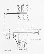
Abb. 6. Schema der Schutzschaltung. - 1 Netztransformator, 2 Schutzschalter.
