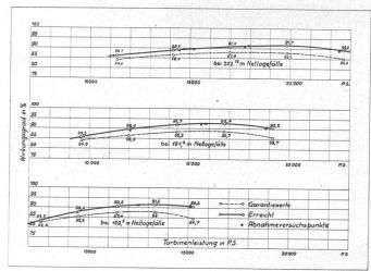
Obenstehende Abbildungen zeigen Ansicht und Wirkungsgradkurve einer der beiden Francis-Spiralturbinen von je 22 650 PS bei 428 t/min in der Zentrale Unteraa (Lungernseewerk) der C. K. W. Luzern. (Totalleistung der von uns für Unteraa gelieferten Turbinen 74 000 PS)
