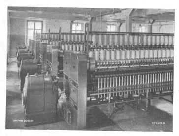
Antrieb von Ringspinnmaschinen durch Dreiphasen-Nebenschluss-Kommutator-Motoren mit Spinnregler.
