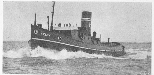
Abb. 4. Englischer Dieselschlepper mit 300 PS-Allen-Motor und „SLM-Winterthur“-Wendegetriebe.
