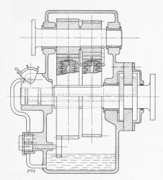
"SLM-Winterthur"-Schiffs-Wendegetriebe Typ MW, mit Zahnradübersetzung für 300 PS bei 560 Uml/min des Motors.
