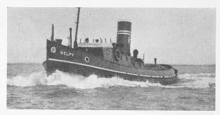
Abb. 4. Englischer Dieselschlepper mit 300 PS-Allen-Motor und "SLM-Winterthur"-Wendegetriebe.
