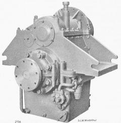
Abb. 1. "SLM-Winterthur"-Schiffs-Wendegetriebe mit Zahnradübersetzung für 300 PS, Typ MW.
