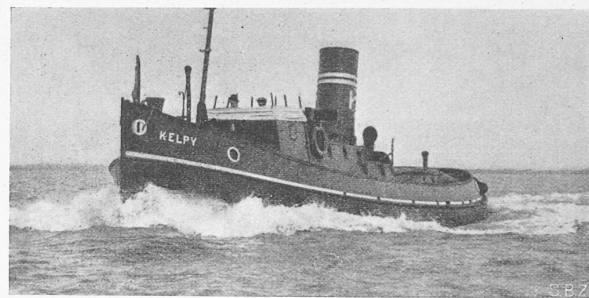
Abb. 4. Englischer Dieselschlepper mit 300 PS-Allen-Motor und „SLM-Winterthur“-Wendegetriebe.
