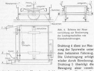
telst einem Hebel am Messrahmen drehbar gelagerten Flaschenrolle. Ueber diese ist ein die beiden Taster I und II verbindendes Kabel geführt. Es wird damit der Mittelwert der Tasterausschläge oder der Abstand der Radebene von der Schiene gemessen. In Kurven ist es notwendig, von dieser Aufzeichnung den Betrag der dem Tasterabstand entsprechenden Bogenhöhe in Abzug zu bringen, was die Kenntnis des Kurvenradius voraussetzt.
