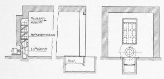
Abb. 1. Elektrisch geheizter Trockenofen
