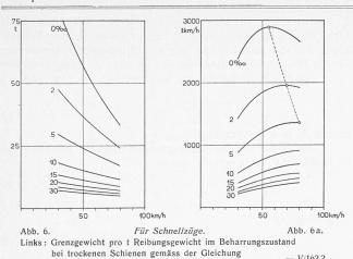
$Q=\frac{285,4\,\mathrm{e}}{5+2,62+0,000\,416\,V^2}$  Abb. 6a. Betriebs-Grenzleistung pro t Reibungsgewicht bei trockenen Schienen gemäss der Gleichung  $B=Q\,V$ .
