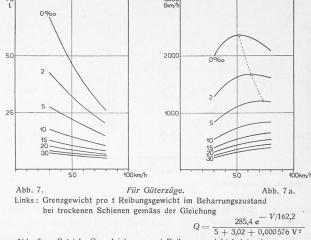
Abb. 7a. Betriebs-Grenzleistung pro t Reibungsgewicht bei trockenen Schienen gemäss der Gleichung B = QV.
