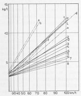
Abb. 5. Fahrwiderstände von Zügen und elektrischen Lokomotiven.
