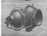
Oben: Keitschleuer 2500mm Nennweite, 7 at Druck, für ein Kraftwerk in Spanien. — Unten: Dreh- in der Schweiz. schleber 1500mm Nennweite, 15 at Druck, für ein automatisches Kraftwerk in Deutschland. speicherwerk in Italien.
