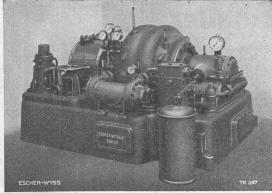
Koks-Gasgebläse mit Dampfturbinenantrieb
