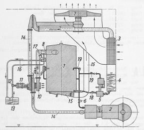
Abb. 1. Schema von Kessel und Maschine des Doble-Dampftriebwagens.
