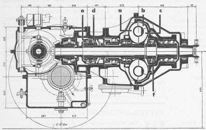
Abb. 2. Trilokgetriebe für Dieseltriebwagen. — a Pumpenrad der Antriebseite, b Turbinenrad der Abtriebseite, c Leitapparat, d, e Gesperre, f Freilauf zwischen Turbinenrad und Abtriebwelle.
