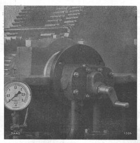
MAAG-ZAHNRAD-SCHMIERPUMPE für Turbogetriebe, mit Handantrieb, zur Erzeugung des Oel-druckes während des Anlaufens der Maschine.
