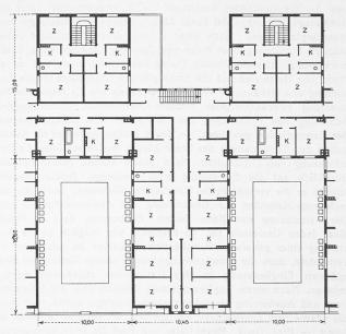
Abb. 4. Normaler Grundriss der Wohngeschosse. - Masstab 1:400.
