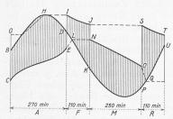
bassin. Das (grössere) Hilfsbassin füllt sich inzwischen, in der Zeit zwischen G und H direkt ans Meer angeschlossen, auf, um sich nun seinerseits, während der Phase F, durch die Turbinen ins Meer zu senken, nachdem der Strom aus diesem durch die Turbinen unterbrochen und direkt ins
